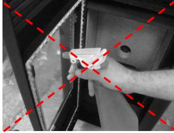
Figura 57 - Limpeza incorreta do vidro
